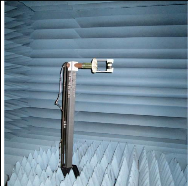
被測定アンテナの回転台
