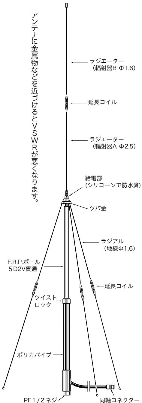
ポリカパイプに収納されているグラスファイバーパイプを伸ばし、3本のラジアルをツバ金の3箇所のフックにそれぞれ押し込み、引っ掛けで固定します。そしてツイストロックを締めて、パイプを固定します。
