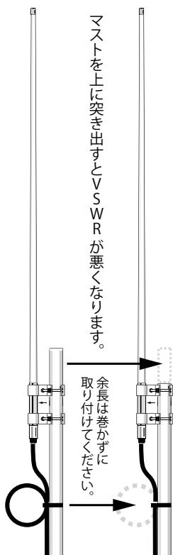
注) アンテナに金属物などを接近させますと V.S.W.R. が悪くなります。
