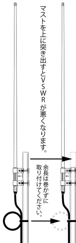
注) アンテナに金属物などを接近させますとV.S.W.Rが悪くなります。アンテナ周囲の障害物から $\lambda/8$ 以上離してください。
