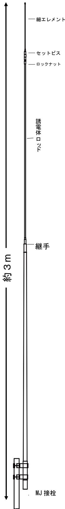
このアンテナはトップローディング方式の、1/2λノンラジアル方式を採用しております。小型ながら効率の良いアンテナです。
