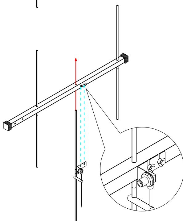
③2番エレメントを矢印の方向でブームの取り付け穴にエレメントの矢印シールが当たるまで挿入し、同時に給電部プレートを蝶ねじとプレートの間に挿入します。
