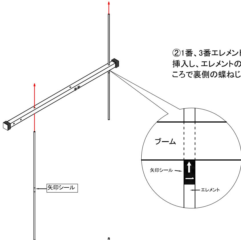
②1番、3番エレメントを矢印の方向でブームの取り付け穴に挿入し、エレメントの矢印シールの端がブーム面に当たったところで裏側の蝶ねじを締めて固定します。
