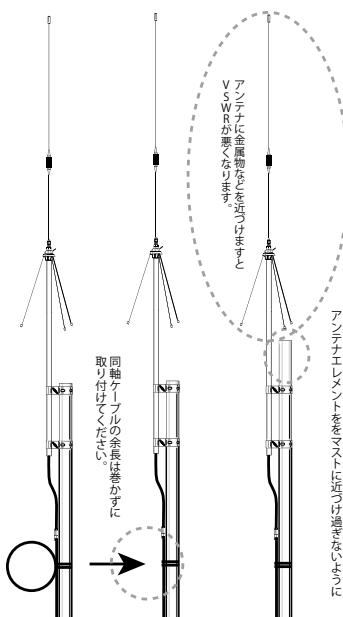
注) アンテナに金属製のマストなどを接近させますと V.S.W.R. が悪くなります。アンテナ周囲の障害物から $\lambda/8$ 以上離してください。
